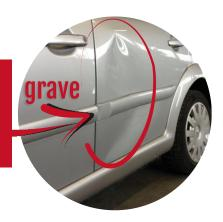
La tecnica Levabolli permette di intervenire senza stucco e verniciatura, mantenendo intatta la vernice originale.
